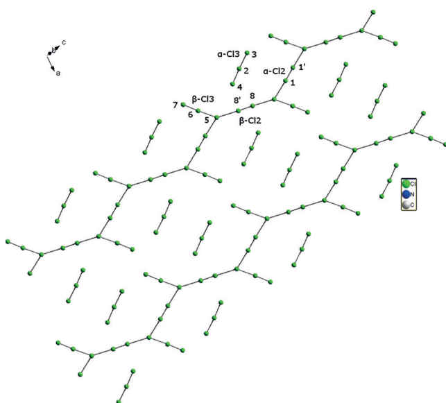
Abbildung 2. Ansicht der anionischen Schichtstruktur von [\text{Et}_4\text{N}]_2-[(\text{Cl}_3)_2\cdot\text{Cl}_2] (Ellipsoide mit 50% Wahrscheinlichkeit). Bindungslängen in pm und -winkel in ^\circ : r_{56} 255.8(3), r_{67} 211.0(3), r_{23} 223.2(2), r_{24} 234.6(2), r_{11'} 202.3(3), r_{88'} 203.7(4), r_{15} 301.9(2), r_{58} 292.0(3); \alpha_{567} 177.4(2), \alpha_{423} 176.5(1).
